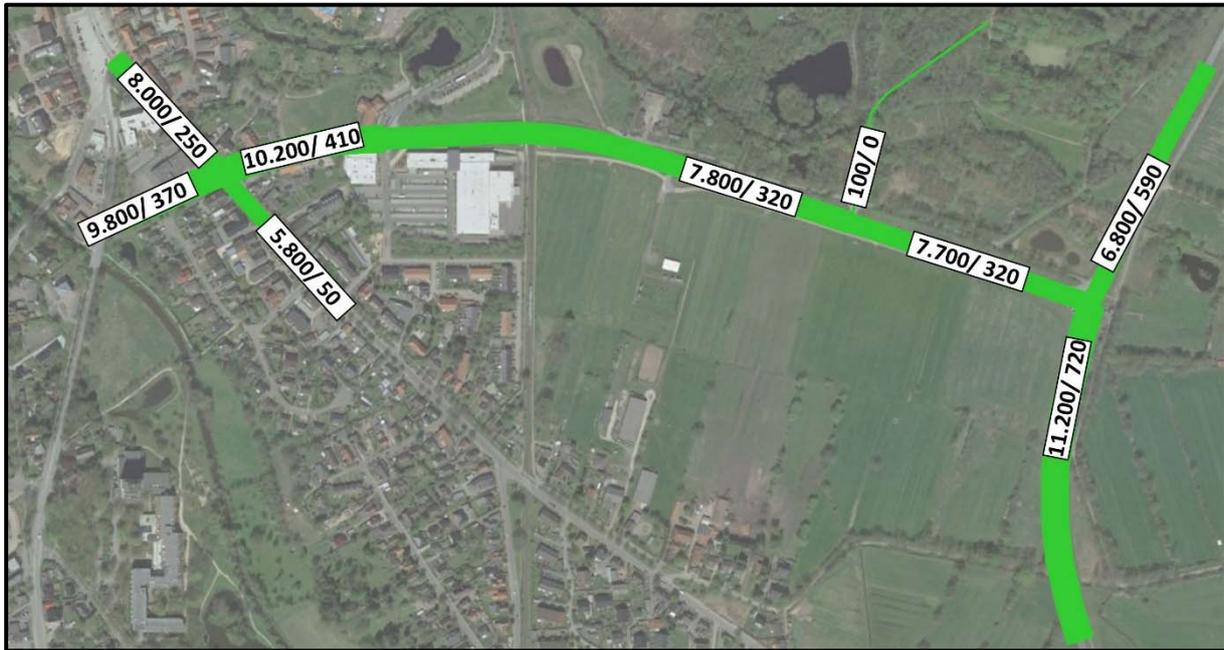
Bild 2.7: Durchschnittliche Tagesverkehrsstärke 2018 (DTV, DTV<sub>SV</sub>)
