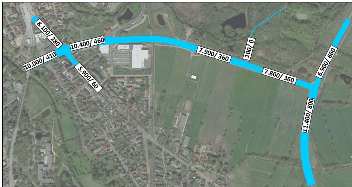
Bild 3.3: Durchschnittliche Tagesverkehrsstärke, PNF 2030 (DTV, DTV<sub>sv</sub>)
